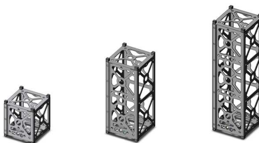
Figura 1. Cubesats do tipo 1U, 2U e 3U.
